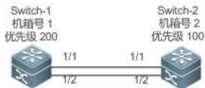
Switch-1 及 Switch-2 组成 VSU，domain 域为 100，左边机箱配置成机箱号 1，优先级 200，别名 switch-1，上面有端口 1/1、1/2 为 VSL 口。右边机箱配置成机箱号 2，别名 switch-2，优先级 100，上面有端口 1/1、1/2 为 VSL 口。
