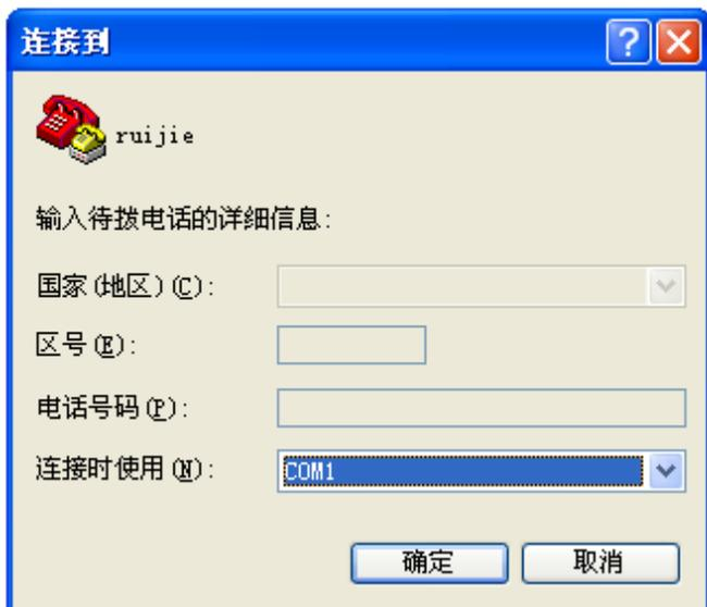
5) .串口选择完毕后，单击<确定>按钮，系统弹出如图 4-5 所示的连接串口参数设置界面，设置波特率为 9600，数据位为 8，奇偶校验为无，停止位为 1，数据流控制为无。
