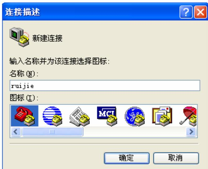
4) 在连接说明界面中键入新连接的名称, 单击<确定>按钮, 系统弹出如图 4-4 所示的界面图, 在 [连接时使用] 一栏中选择连接使用的串口。
