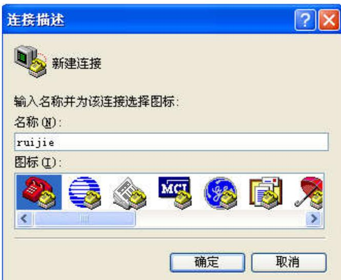
3) 在连接说明界面中键入新连接的名称，单击<确定>按钮，系统弹出（如图 4-4 所示的）连接到界面，在 [连接时使用] 一栏中选择连接使用的串口。
