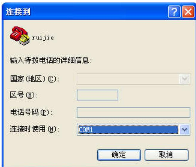
4) 串口选择完毕后，单击<确定>按钮，系统弹出（如图 4-5 所示的）连接串口参数设置界面，设置波特率为 9600，数据位为 8，奇偶校验为无，停止位为 1，数据流控制为无。
