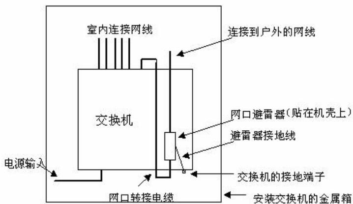
📖 网口避雷器只针对 10/100M 电接口（采用 RJ-45 连接器）的以太网口。
