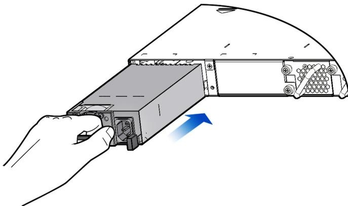
⚡ 只能平稳地插入电源模块。插入时，请注意电源面板的方向，不要插错。
