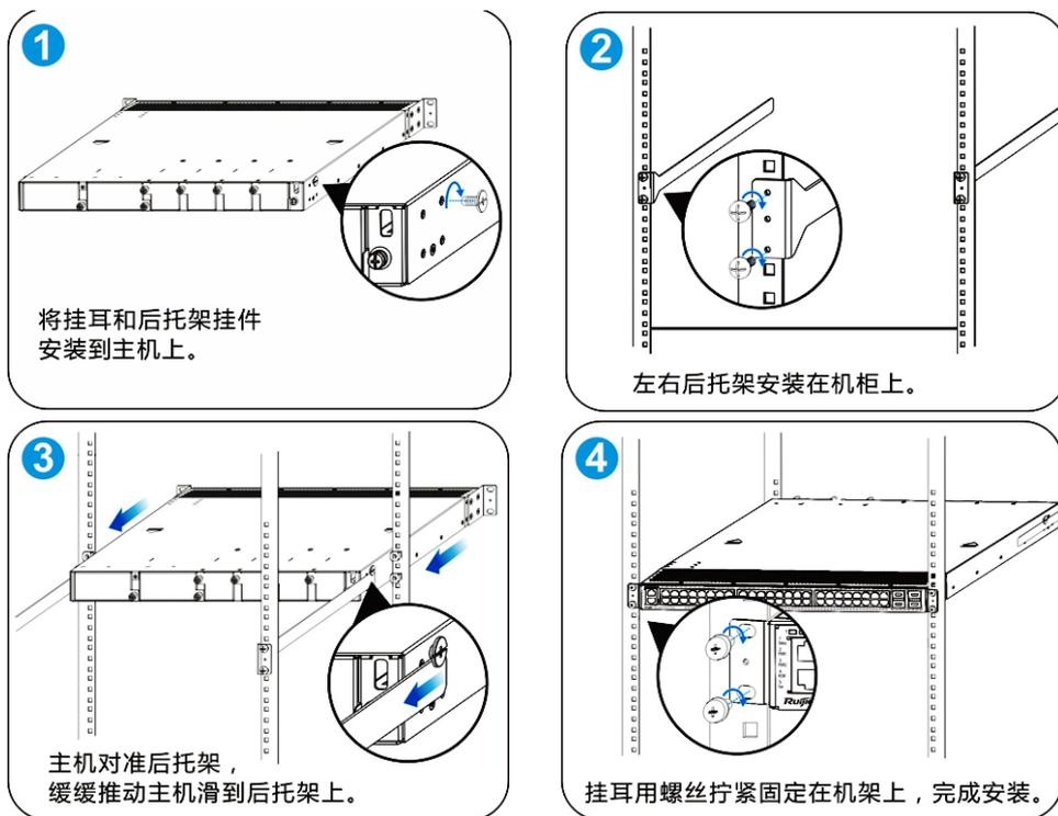
挂耳安装的位置是主机后面板边上六个螺丝孔中左右两排四个螺丝孔。
