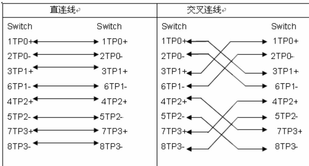
100BASE-TX 除了可用以上规格的线缆相互连外，还可以用 100-ohm 5 类线互连，最长都可支持 100 米的连接距离。以下是 100BASE-TX 时的引脚信号定义。
