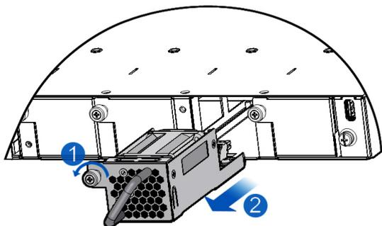
⚡ M6220-FAN II-F 风扇模块在拉出的过程中，要保证风扇模块被笔直地缓慢拔出。
