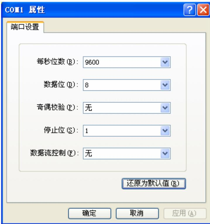
5) 串口参数设置完成后，单击<确定>按钮，系统进入（如图 4-6 所示的）超级终端界面。
