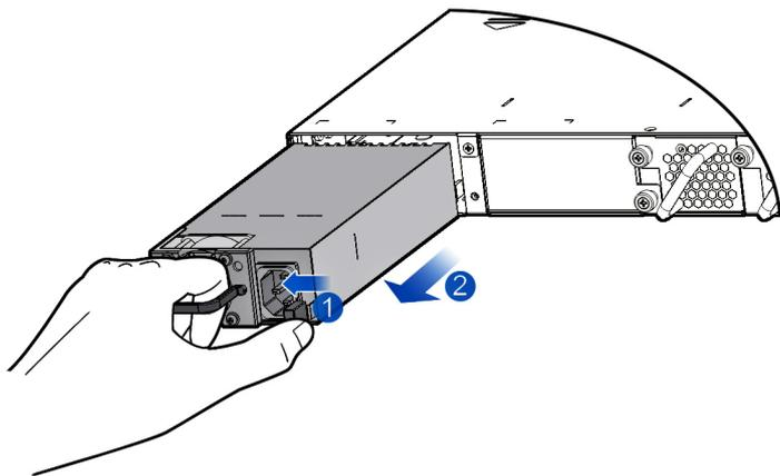
⚡ RG-M6220-AC460E-F 电源模块在拉出的过程中，要保证电源模块被笔直地缓慢拔出。
