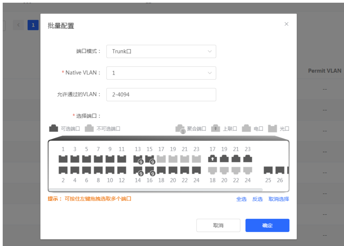
图 4-2-4 端口 VLAN 配置
