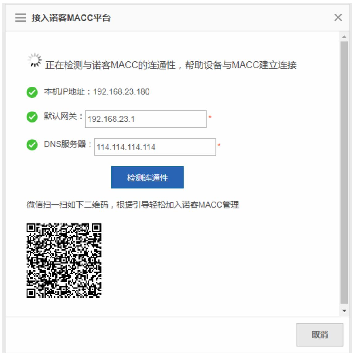
配置本机 IP、默认网关及 DNS 服务器后,可以点击“检测连通性”查看设备是否可以连上诺客云管理,连通后扫一扫二维码将设备加入诺客云 MACC 管理平台。
