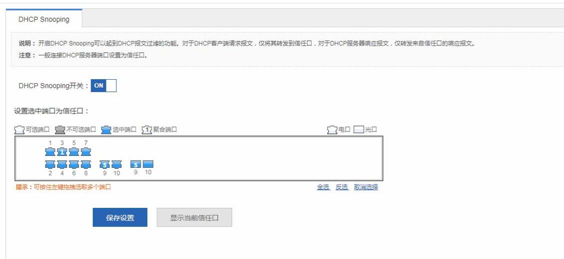
DHCP 开关开启后，DHCP SERVER 连接的端口需要设置为 DHCP 信任口，非信任口上的 DHCP SERVER 无法正常工作。面板上选中端口代表该端口开启了 DHCP 信任口。用户可直接在面板上选中端口然后点击<保存设置>按钮。
