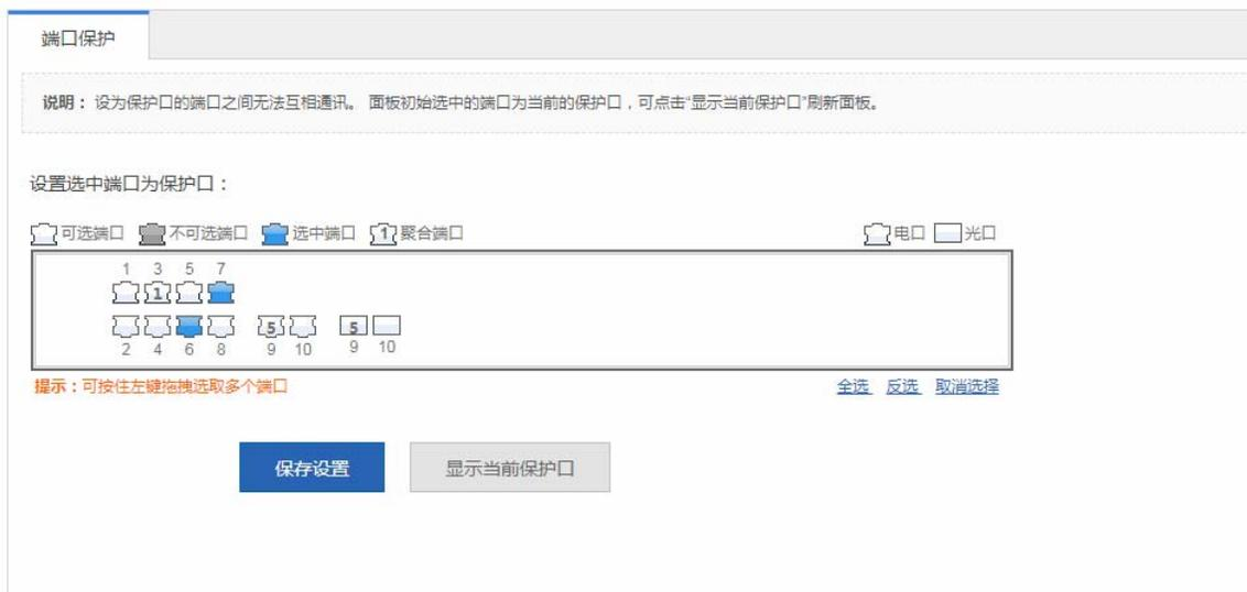
设置端口为保护口，选择面板中端口，点击“保存设置”提示“设置成功”即可。
