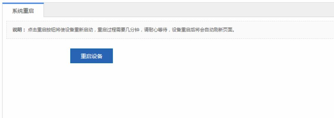
点击<重启设备>，提示“确定要重启设备？”，点击<确认>按钮后实现设备重启。重启过程需要数分钟时间，请耐心等待，设备重启后将会自动刷新页面
