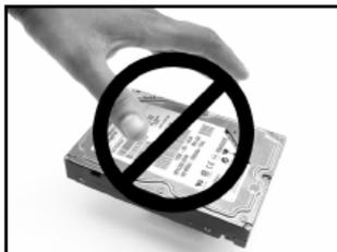
不要用手或工具接触印刷电路板部件。
