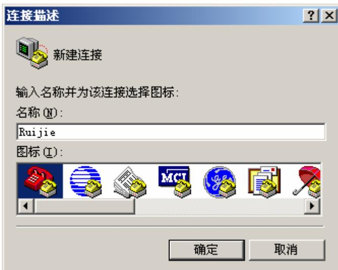
图 4-2 选择和产品的 Console 连接的微机串口
