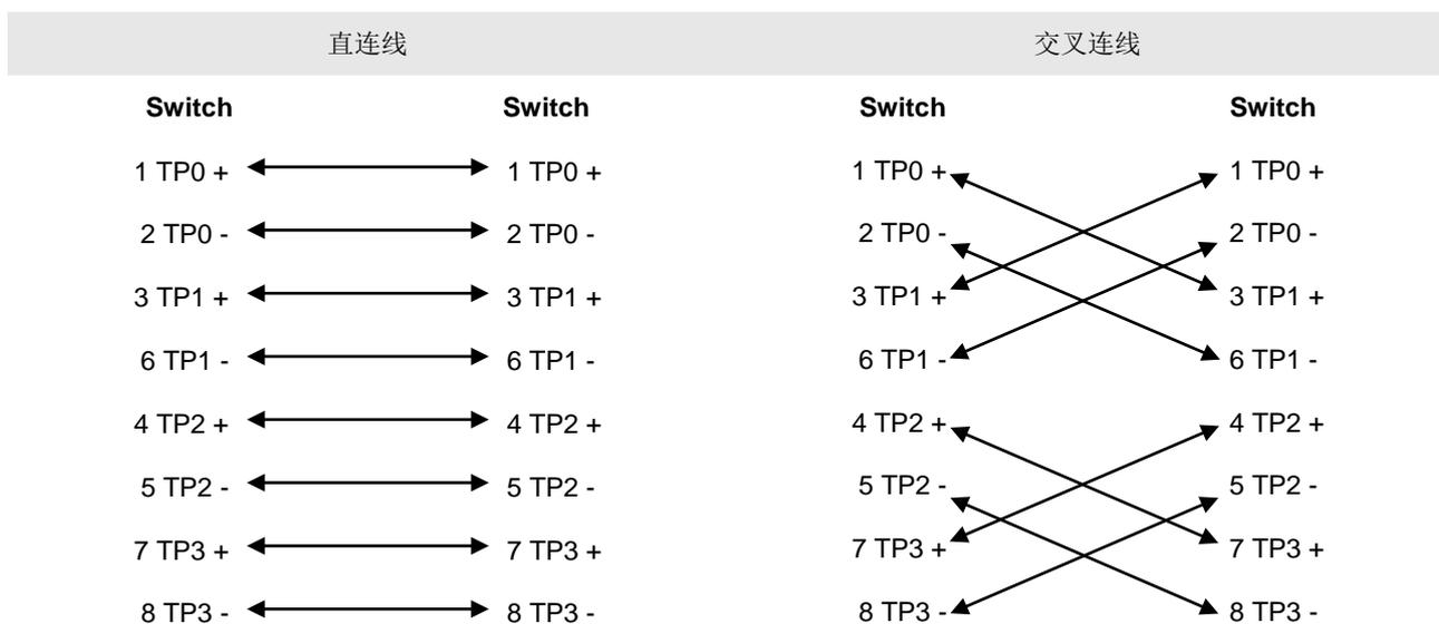
100BASE-TX/10BASE-T 除了可用以上规格的线缆相互连外，对于 10Mbps 可以用 100-ohm 3, 4, 5 类线，对于 100Mbps 联接用 100-ohm 5 类线相互连，最长都可支持 100 米的连接距离。以下是 100BASE-TX/10BASE-T 时的引脚信号定义。
