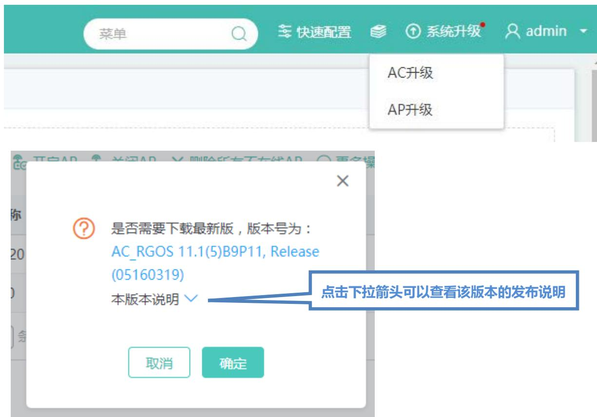
点击『确定』按钮将下载文件到用户电脑上，web 会自动跳转到 AC 升级菜单，并以如下提示引导用户进行下一步操作。
