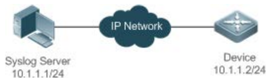
图 1-2 系统日志发送到日志服务器组网图
