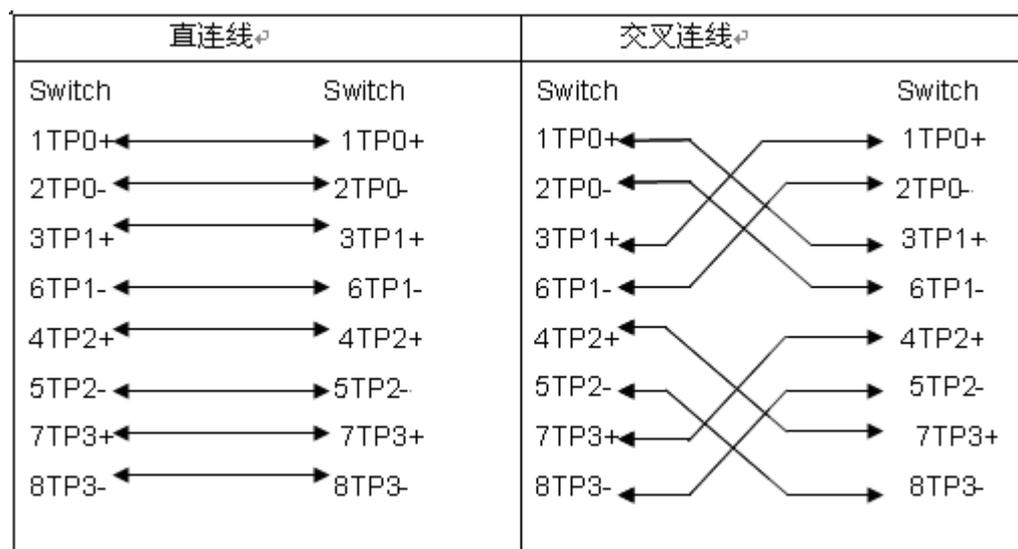
100BASE-TX/10BASE-T 除了可用以上规格的线缆相互连外，对于 10Mbps 可以用 100-ohm 3,4,5 类线，对于 100Mbps 联接用 100-ohm 5 类线相互连，最长都可支持 100 米的连接距离。以下是 100BASE-TX/10BASE-T 时的引脚信号定义。
