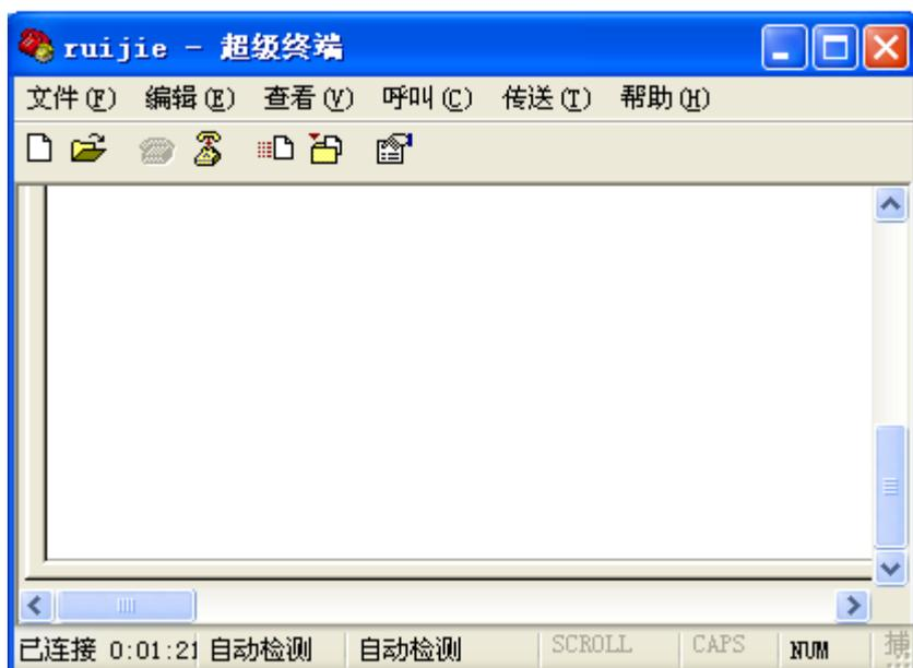
目前, 很多 PC 硬件上已经没有 Console 接口, 而且系统已经不支持超级终端了, 因此我们需要使用 Console 转 USB 数据线以及在 PC 端使用终端仿真器 (比如 SecureCRT) 软件对设备进行配置。
