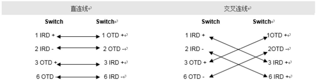
图A-3 100BASE-TX/10BASE-T双绞线联接方式
