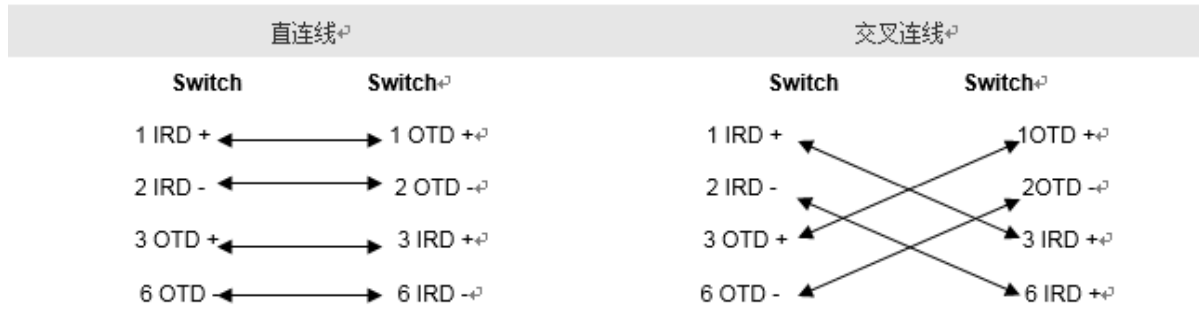
图6-2 100BASE-TX/10BASE-T 双绞线连接方式
