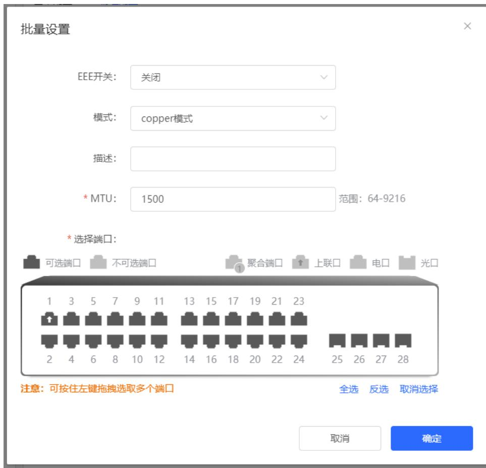
设置单端口：点击端口表项操作列的<修改>，在配置信息框中选择EEE开关、端口模式，并输入端口描述，点击<确定>。
