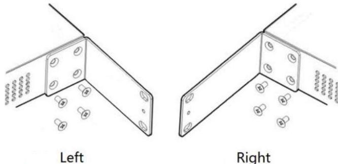
(2) 使用自带螺钉和笼型螺母将挂耳固定在机柜上，如图2-4所示。
