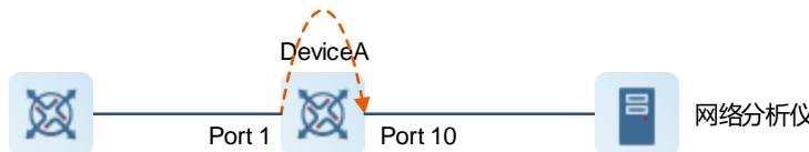
镜像功能既实现了对可疑的网络节点或者设备端口进行数据流量分析，同时又不影响被监控设备的数据转发，主要应用于网络监控和故障排查场景中。
