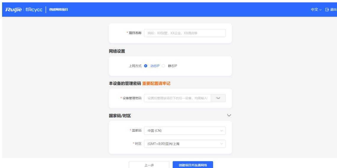
点击<创建项目并连通网络>, 设备将下发初始化相关配置, 并检测网络。完成快速配置后, 新设备已联网, 可继续将设备绑定云端账号, 进行远程管理, 具体操作请参考页面指引登录诺客云平台进行配置。
