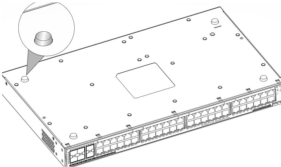
第二步：将交换机平放在桌面上，以确保交换机的周围的空气能够良好地流动通风，如图2-2所示。
