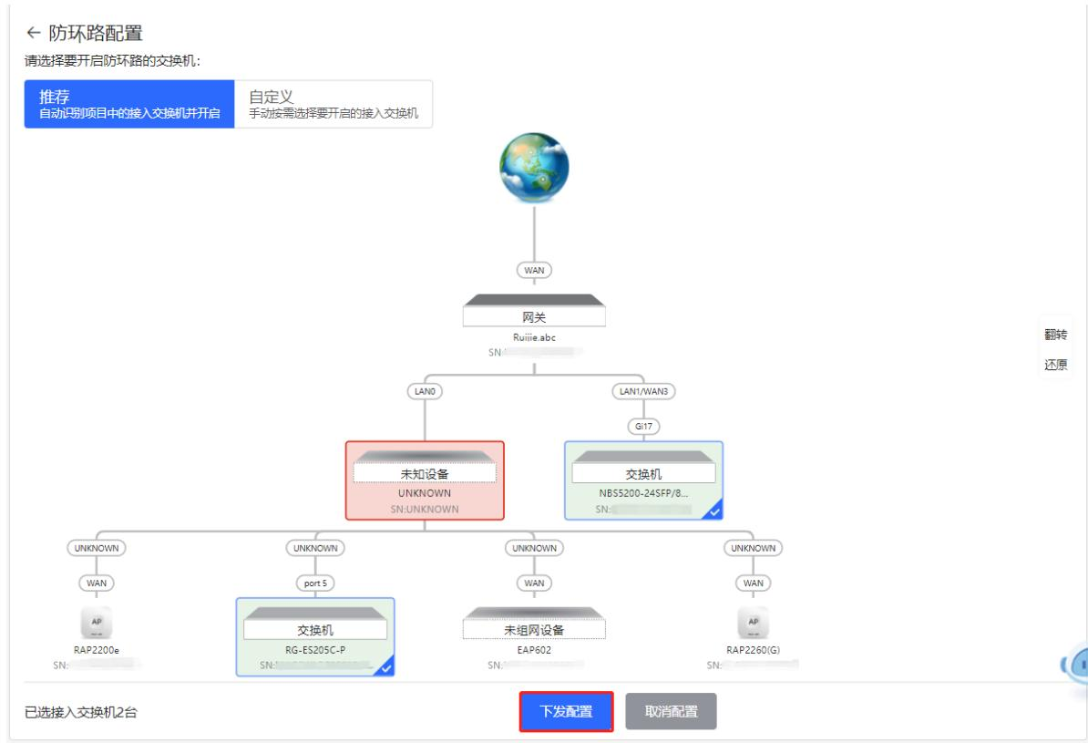
(3) 完成配置下发后，如需修改防环路功能的生效范围，点击<前往配置>，可在拓扑中重新选择开启防环路的交换机。点击防环路开关，可一键关闭网络中所有交换机上的防环路功能。
