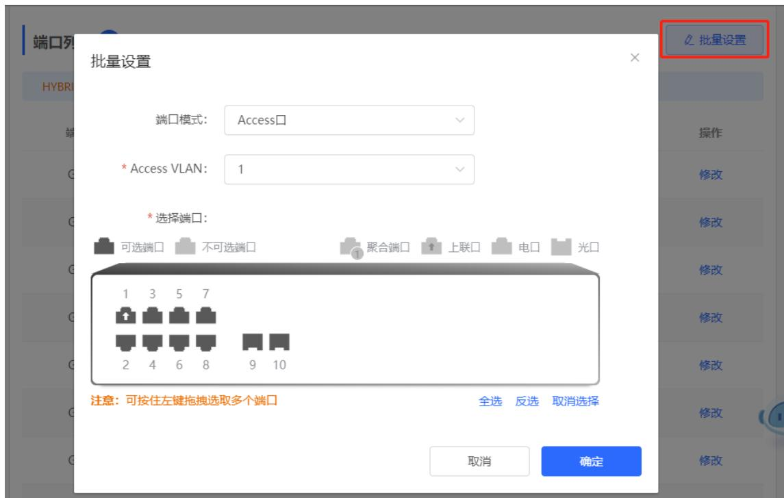
设置单端口：点击“端口列表”中指定端口最后一列操作栏下的<修改>，设置端口模式及对应VLAN，点击<确定>。
