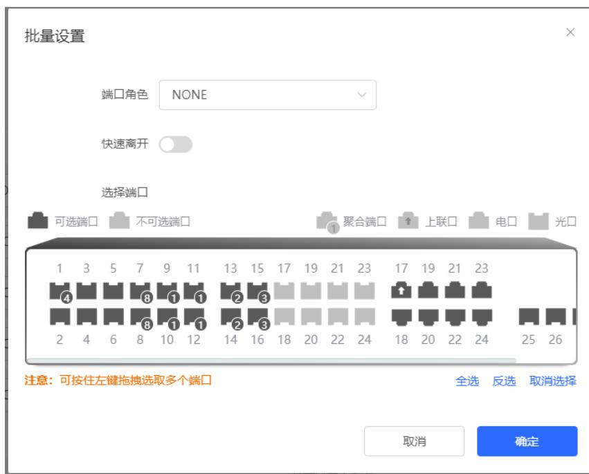
设置单端口：点击下拉框选择端口的MVR角色类型。点击“快速离开”列的开关可以设置端口是否开启快速离开功能。
