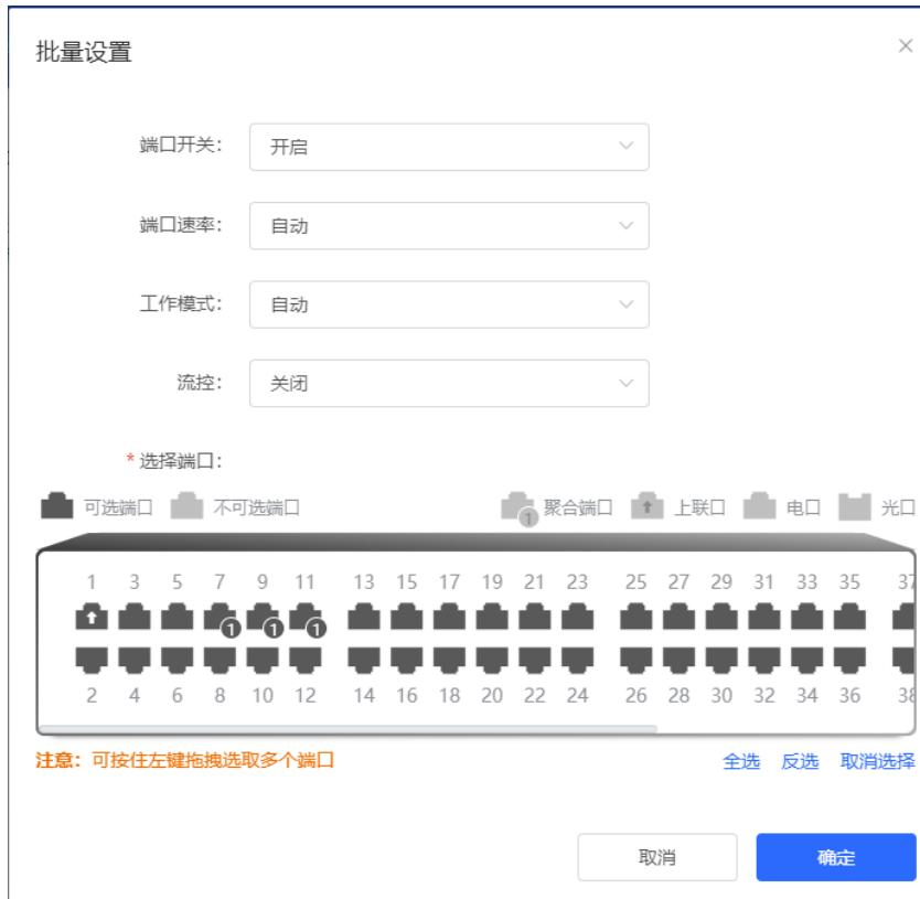
设置单端口：在端口列表中选择需要设置的端口表项，点击操作列中的<修改>，在配置框中选择端口启用状态、速率、工作模式和流控模式，点击<确定>。
