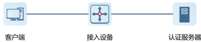
图8-1 802.1x 系统典型架构
