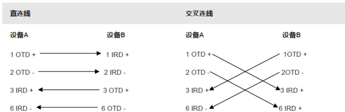
图7-3 100BASE-TX/10BASE-T 双绞线联接方式示意图
